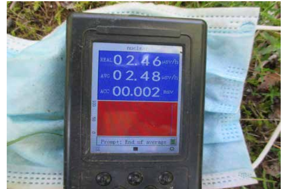
Fig. 9: Lo strumento posto sulla mascherina che era stata indossata in grotta il giorno 8 settembre 2020, segna un valore medio di 2,48 \mu\text{Sv}/\text{h} .
