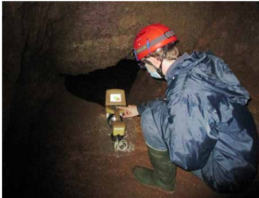
Fig. 18: Ricerca dei radionuclidi tramite uno spettrometro gamma nel punto 6 della caverna.
