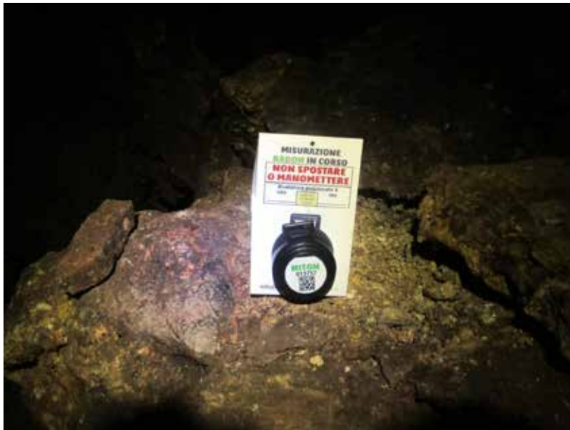
Fig. 11: Il rilevatore CR39 collocato nel punto 7 della grotta il 13 agosto 2020 e recuperato il 24 agosto 2020.
