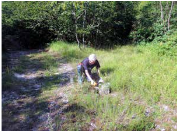
Fig. 14: Alcune misure sono state eseguite anche in superficie, nei pressi della caverna. Nella foto, in luglio si rilevano la concentrazione di CO 2 e la radioattività in una frattura della roccia, che continua con un vuoto sotterraneo, al momento non accessibile. I valori di CO 2 erano continuamente fluttuanti, mediamente tra 600 e 700 ppm e con un massimo fino a 1025 ppm. La radioattività era 0,21 µSv/h.
