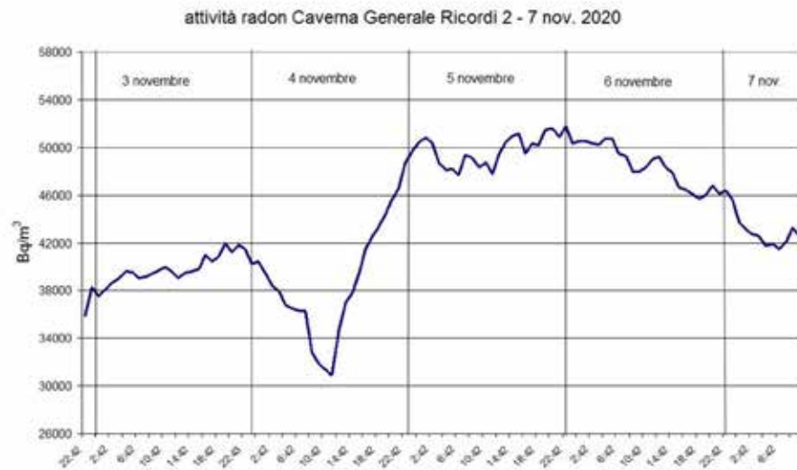
Fig. 16: Concentrazioni dell'attività del radon, dalle ore 22:42 del 2 novembre, alle ore 9:42 del 7 novembre 2020. Fig. 16: Concentrations of radon activity, from 10:42 pm on November 2, to 9:42 am on November 7, 2020.
