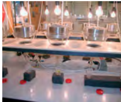
Fig. 4 - I selettori di Berlese-Tullgren impiegati
